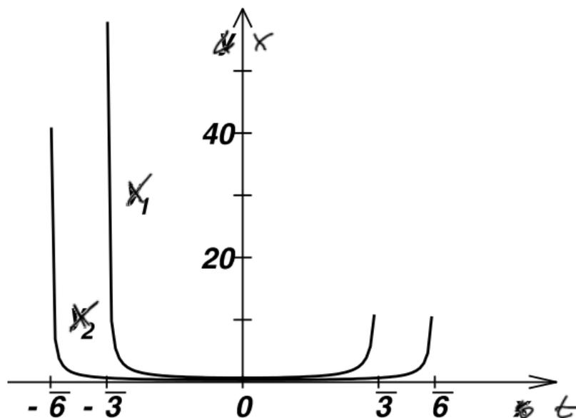
**Abbildung 6.3:**  $\dot{x}(t) = tx(t)^2$  hat Lösungsschar  $x(t) = \frac{1}{C-t^2/2}$  mit  $C = \frac{1}{x_0} + \frac{t_0^2}{2}$ , falls  $(t_0, x_0)$  den Anfangswert bezeichnet. Dargestellt sind die Lösungen  $x_1$  und  $x_2$  der Differentialgleichung für  $(t_0, x_0) = (1, 1)$ , d.h.  $C = 1,5$ , und  $(t_0, x_0) = (2, 1)$ , d.h.  $C = 3$ .
