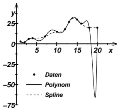
**Links: Abb. 2.70: Kubischer interpolierender Spline und Interpolationspolynom 8. Grades.**
