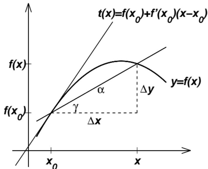
Abbildung 2.30: Sekante und Tangente an  $f$  in  $x_0$
